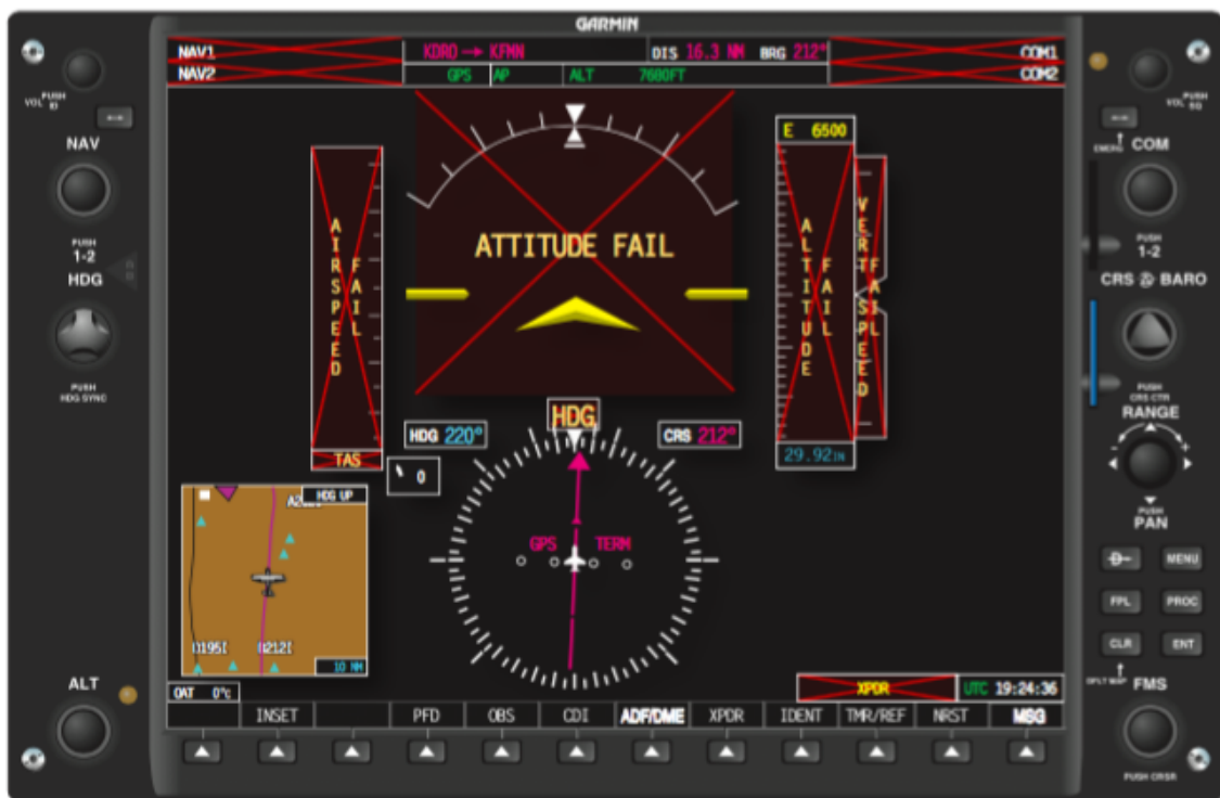
Figura 2-8. Las inspecciones en tierra incluyen la verificación de que se muestran "X" en la pantalla del instrumento hasta que se activa el sensor.
