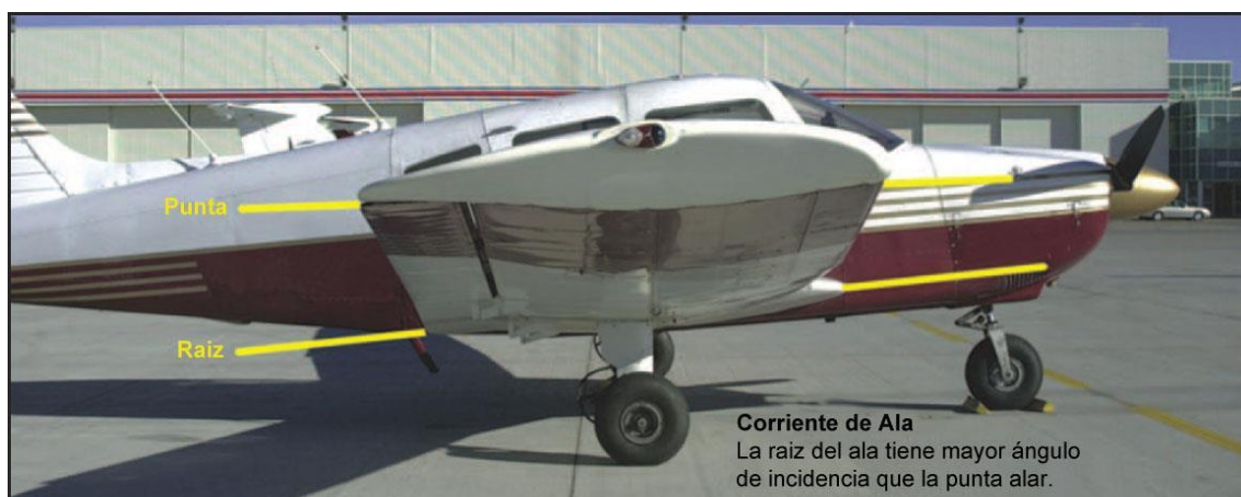
Figura 4-4. Corriente o flujo en la punta alar.
