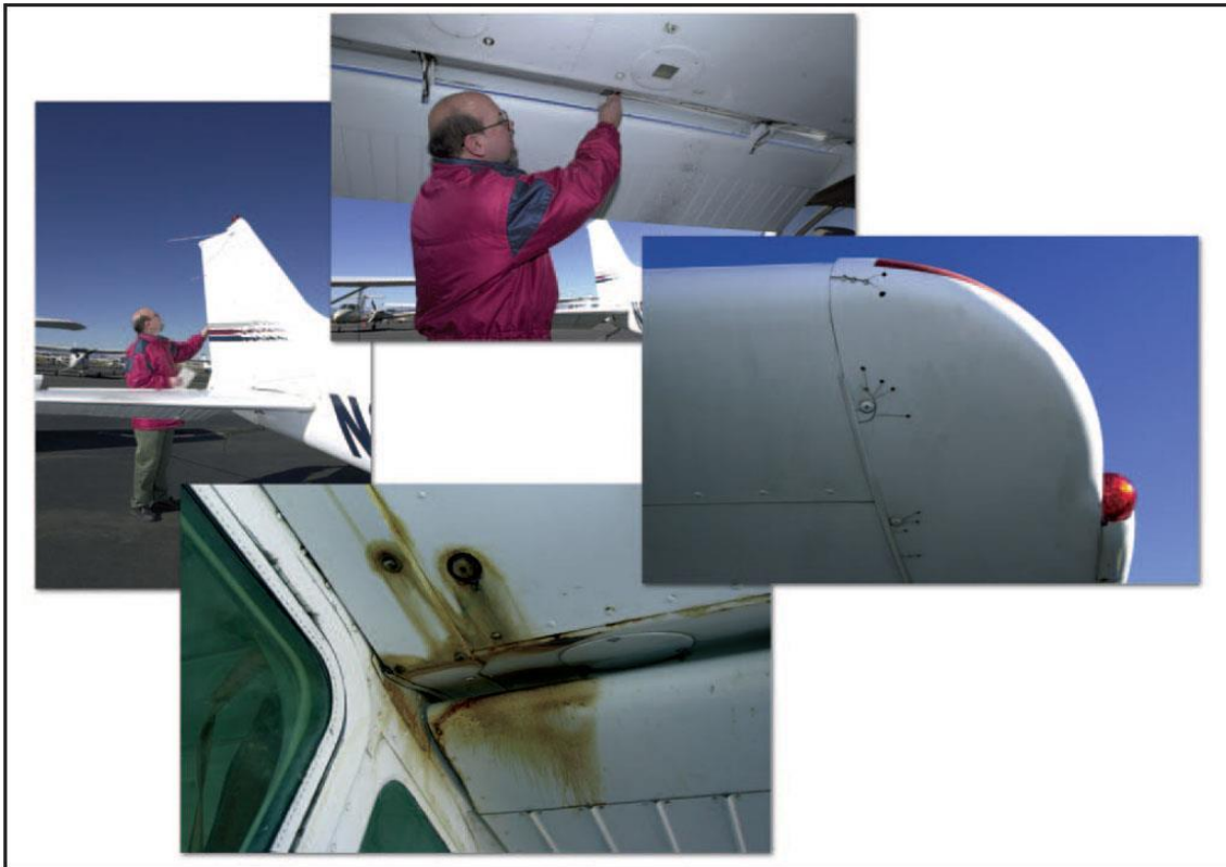
Figura 2-9. Inspección del ala y sección de cola.
