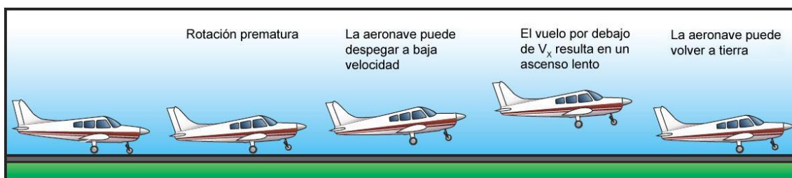
Figura 5-8. Efecto del despegue prematuro.
