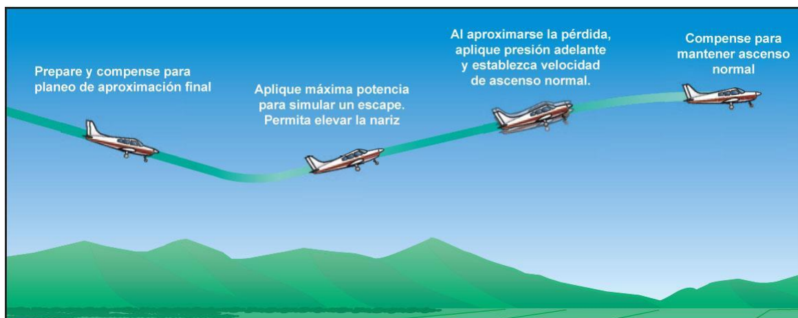
Figura 4-8. Pérdida por compensador de timón de profundidad.
