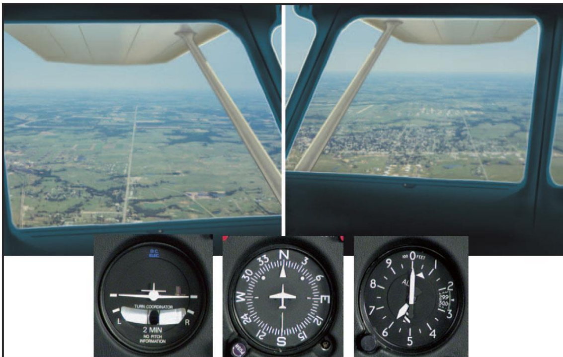
Figura 3-4. Referencia a las puntas alares para vuelo recto y nivelado.
