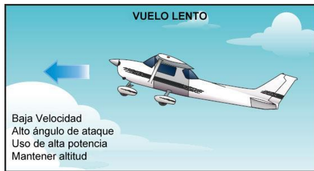
Figura 4-1. Vuelo lento – Baja velocidad, gran ángulo de ataque, alta potencia y altura constante.
