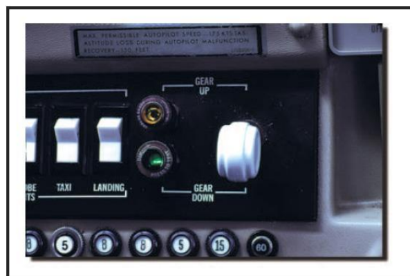
Figura II-7. Interruptores e indicadores de posición de tren de aterrizaje.
