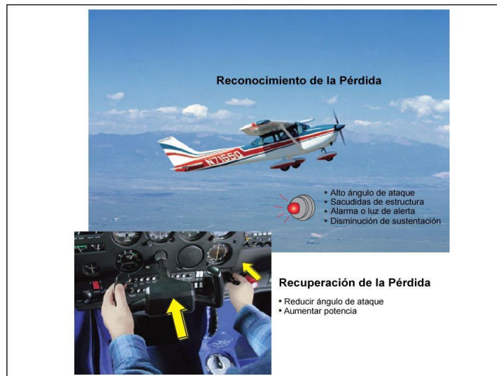
Figura 4-3. Reconocimiento y recuperación de una pérdida.
