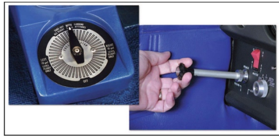
Figura 2-6. Selector de combustible e inyector.
