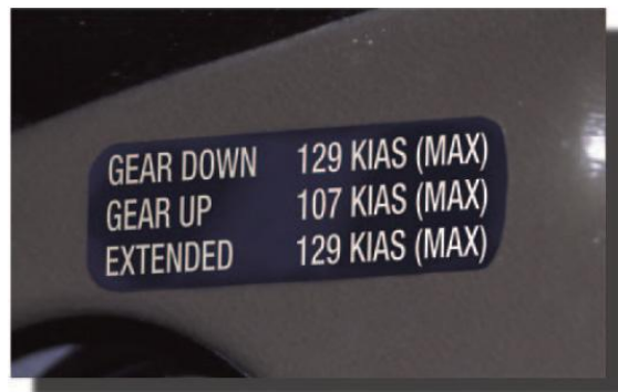
Figura 11-11. Carteles en cabina con las velocidades del tren.
