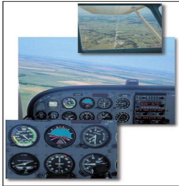
Figura 3-5. Viraje nivelado a izquierda.
